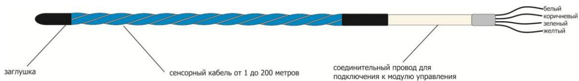
Подключается ко всем типам модулей: LDM5.0, LDM200, LDM200D, SWF200, SWF5.1M
